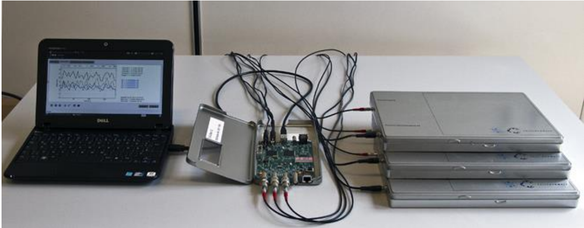
Abb. 4: Anschluss der Szintillatorplatten an eine DAQ – Karte
