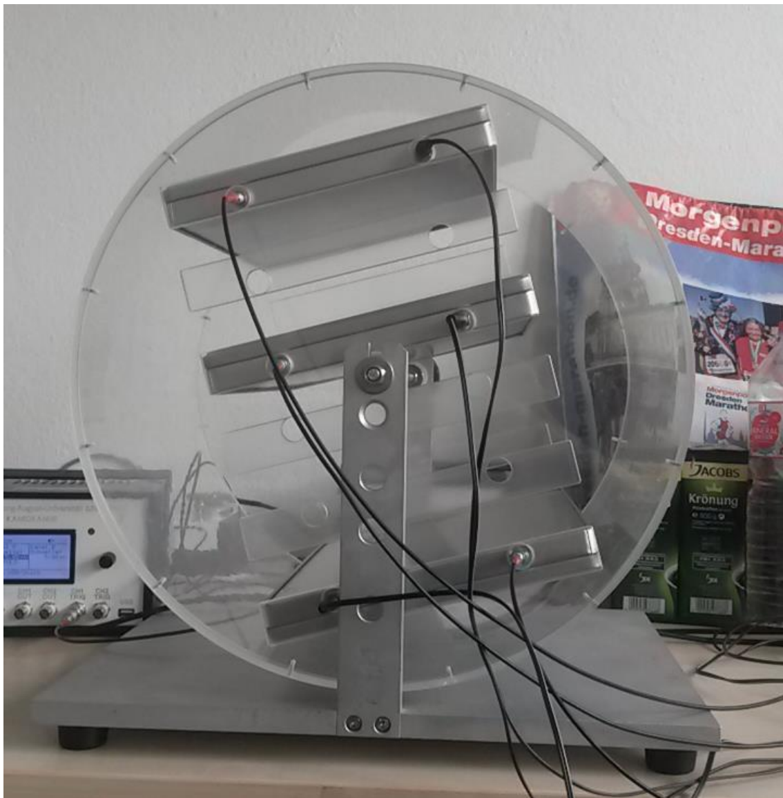
Abb. 6: Auf den Winkel 15^\circ ausgerichtete Szintillatorplatten
