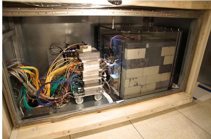
Abbildung 2.10: Aufbau des COBRA-Experiment mit den verschiedenen Abschirmungsschichten.
