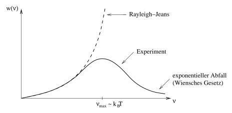
Zur Lösung des Problems nahm Planck an, dass die stehenden elektromagnetischen Wellen in Resonanz mit gewissen (nicht näher charakterisierten) Oszillatoren in der Innenwand des Hohlraums stünden und dass diese nur in Zuständen mit bestimmten diskreten Energien  $E_n = n\varepsilon$ ,  $n = 0, 1, 2, \ldots$  existieren können. Man zeigt in der Statistischen Physik, dass die mittlere Energie eines solchen Oszillators dann
