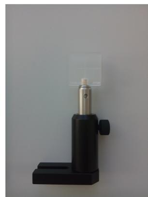
Praktische Justagehilfe für den Laserstrahl: Mattiertes Pexiglas mit Skala in horizontaler und vertikaler Richtung.
