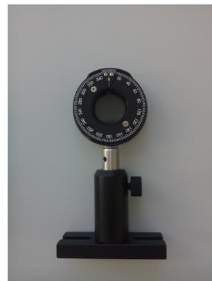
Polarisationsfilter  $P_1/P_2/P_3$  mit Skala zur Messung des Polarisationswinkels (Skaleneinteilung in  $2^\circ$ -Schritten).
