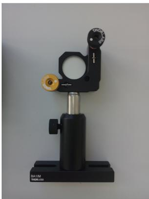
Vollreflektierender Spiegel  $S_1/S_2$  in vertikal und horizontal verkipbarer Fassung.
