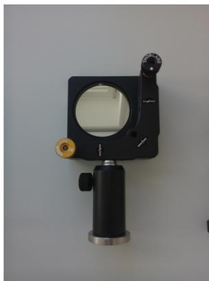
Strahlteiler  $T_1/T_2$  in vertikal und horizontal verkipbarer Fassung. Hier: Variante mit Magnetfuß.
