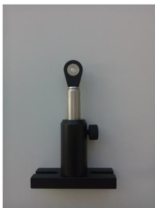
Aufweitungslinse  $L_2$  mit  $f = 10$  mm Brennweite für die Position am Ausgang des MZIs.
