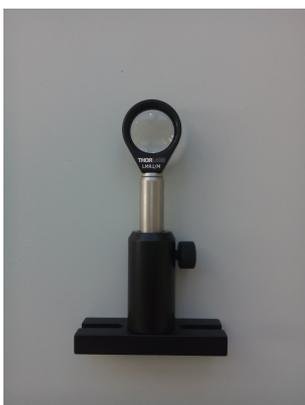
Aufweitungslinse  $L_1$  mit  $f = 50$  mm Brennweite für die Position am Eingang des MZIs.
