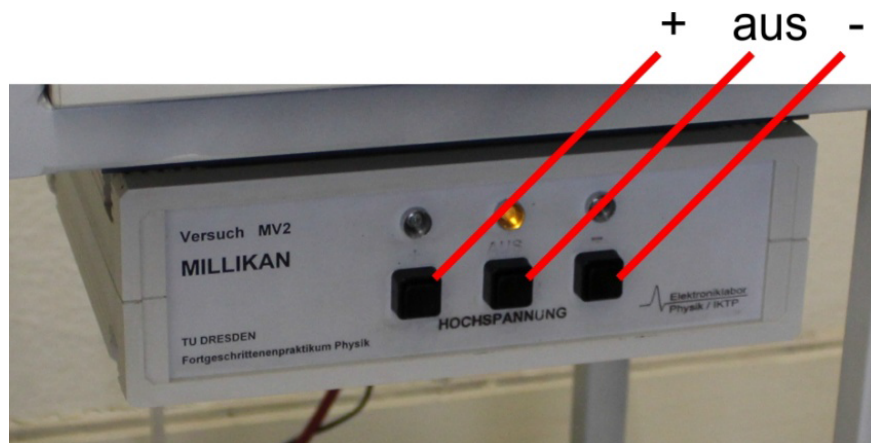
Abb. 2: Umschaltung für die Hochspannung. Damit kann die Polarität der Hochspannung an dem Plattenkondensator um- oder ausgeschaltet werden.
