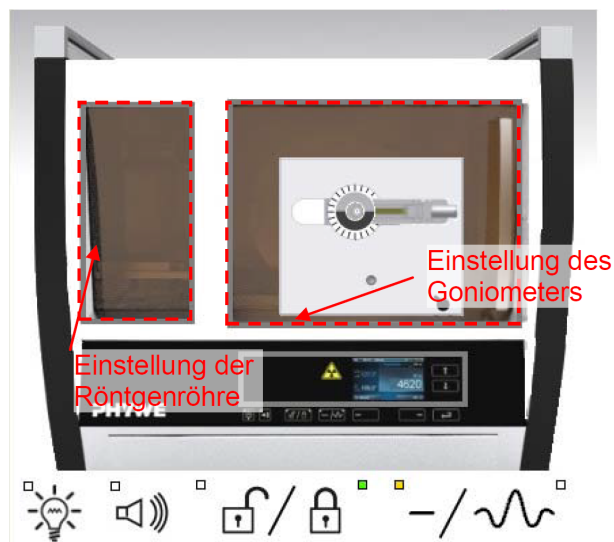
Abb. 10: Röhren- und Goniometereinstellungen mit dem Programm measure , Quelle: PHYWE.
