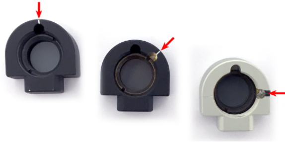
Abb. 13: Die an den Polarisatoren (Polaroidfolien, von links nach rechts P1, P3, P2) angebrachten Kennzeichnungen entsprechen der Richtung der langen Polymerketten
