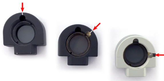
Abbildung 13: Die an den Polarisatoren (Polaroidfolien, von links nach rechts P1, P3, P2) angebrachten Kennzeichnungen entsprechen der Richtung der langen Polymerketten
