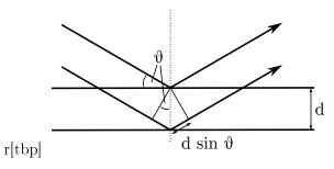
**Abb. 3:** Bragg-Reflexion im Glanzwinkel  $\vartheta$  an zwei Netzebenen.
