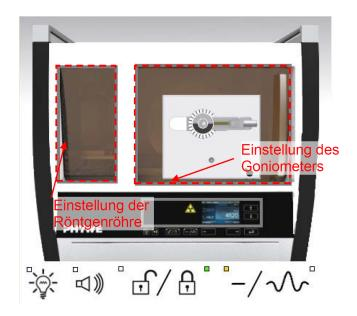
Abb. 4: Röhren- und Goniometereinstellungen mit dem Programm measure, Quelle: PHYWE.
