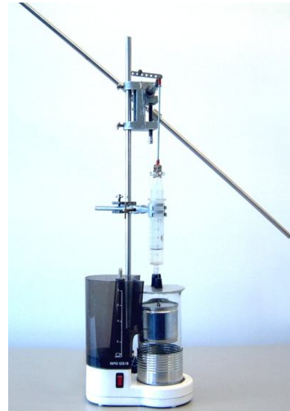
Stirlingmotor, hergestellt im Rahmen einer Wissenschaftlichen Arbeit in der Didaktik der Physik
