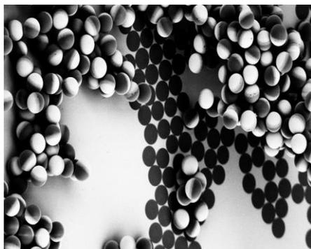
*Elektronenmikroskop-Aufnahme der nanoskaligen Januspartikel, an deren potentiellen Einsatz als photokatalytische Nanomotoren die Freigeist-Nachwuchsgruppe forschen wird. Copyright: Juliane Simmchen*
