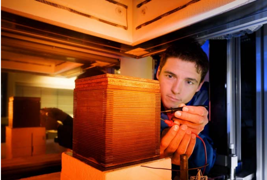
Stack für die Hochtemperaturbrennstoffzelle (SOFC): Energiequelle der Zukunft.
