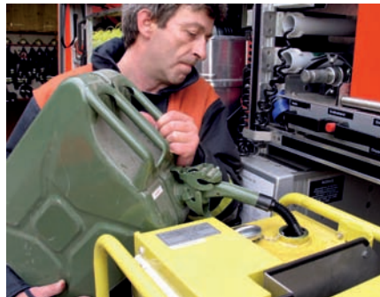
Kraftstoffbehälter nur bei abgestelltem Motor und mit Trichter oder Einfüllstutzen betanken
