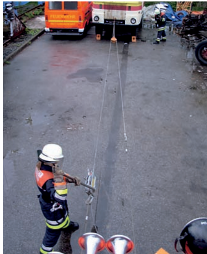
Die durch den Mehrweckzug aufzubringende Zugkraft verdoppelt sich durch den Einsatz der losen Rolle.
