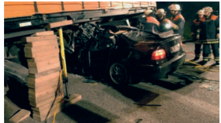
Kombination: Unterbau durch Rüsthölzer und Abstützung durch Rettungszylinder
