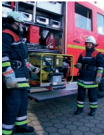
Beispielhaft – durch tiefe Lagerung des Stromerzeugers ergeben sich ergonomisch günstige Griffhöhen.
