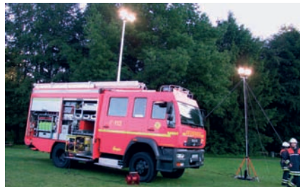
Lichtmast am Löschfahrzeug und abgespanntes Teleskop-Dreibeinstativ
