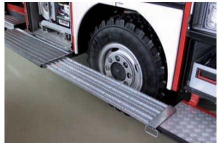
Sichere Geräte-Entnahme. Durch den Auszug lässt sich die Lücke schließen und ein sicherer Auftritt auch über die ganze Aufbauhöhe herstellen.
