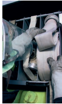
Gefahr! Die Kupplung des unsachgemäß verlasteten Rollschlauches kann herabfallen.
