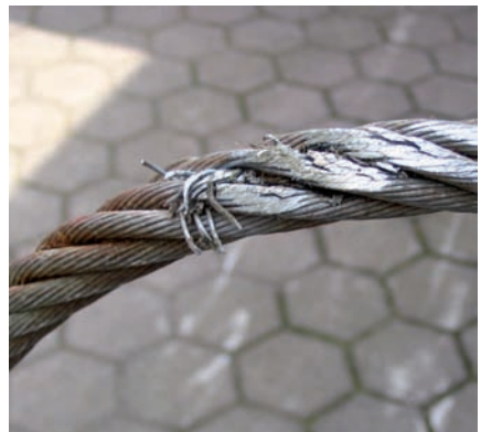
Dieses Stahldrahtseil ist ablegereif!
