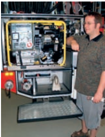
Ungünstige Lagerung des Stromerzeugers – eine körpergerechte Entnahme des schweren Gerätes ist nicht möglich.
