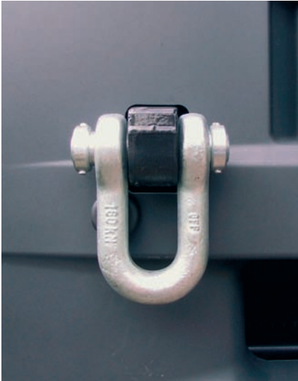
Festpunkt am Feuerwehrfahrzeug (160 kN)
