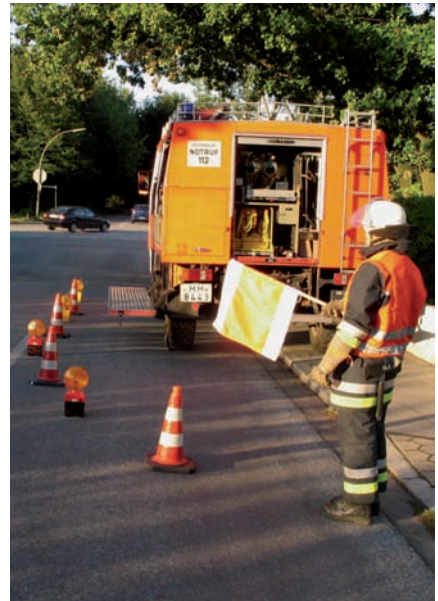
Sperrung einer Fahrspur mit Verkehrsleitkegeln und Blitzleuchten
