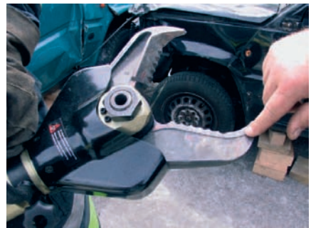
Sichtprüfung der Schneidmesser
