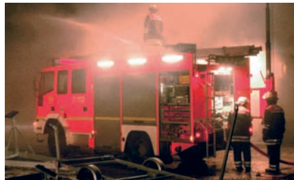
Fahrzeug-Umfeldbeleuchtung und Lichtmast am Löschfahrzeug zur Einsatzstellenbeleuchtung
