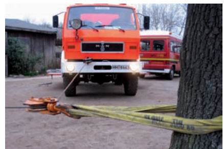
Das Feuerwehrfahrzeug steht auf Grund der Bedingungen an der Einsatzstelle ungünstig zur Last. Der Einsatz der Seilwinde ist nur unter Umlenkung der Zugrichtung möglich.
