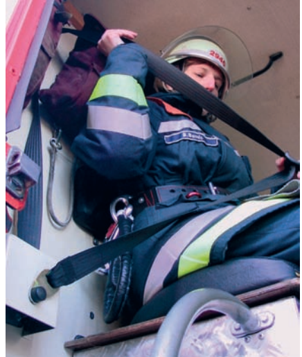
Nachgerüsteter Sicherheitsgurt mit Aufrollautomatik im Mannschaftsraum
