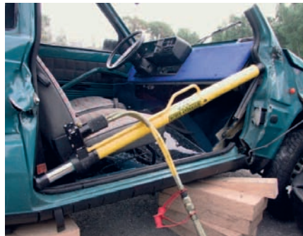
Einsatz eines Rettungszyklinders
