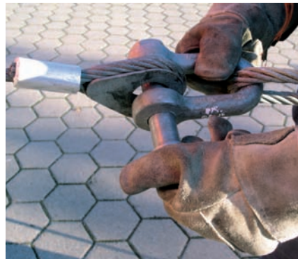
Zugseile und Anschlagseile nur mittels Schäkel verbinden
