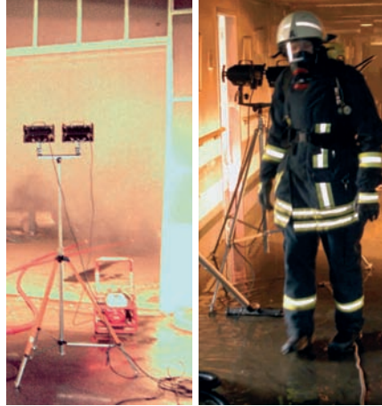
Einsatzstellenbeleuchtung durch Halogen-Flutlichtstrahler auf Teleskop-Dreibeinstativ
