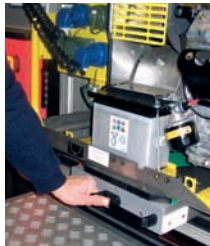
... weil beim Einschieben des Stromerzeugers der vorhandene Handgriff nicht benutzt wird.
