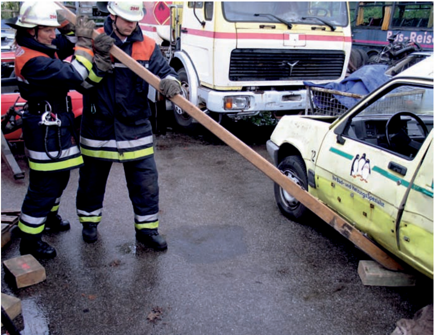
Schnelle Lastbewegung mittels Hebebaum
