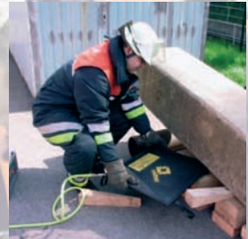
Druckkissen weit einschieben – mind. 75 % unter die Last
