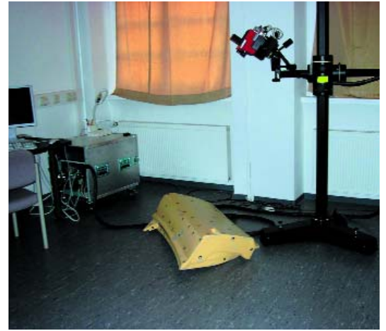
Abb. 1: Scannen einer Autotür eines Prototypen der Fa. Funke und Will Großenhain
