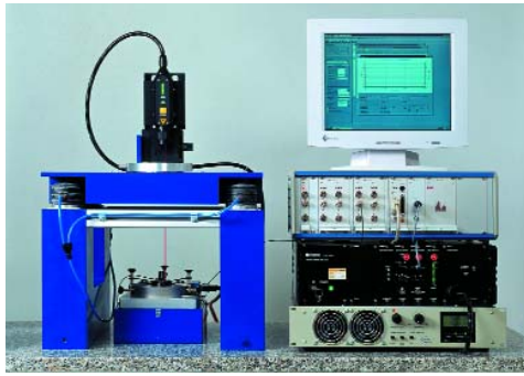
CS18P HF, Kalibriersystem mit Laser-Interferometer von Polytec zur Absolutkalibrierung von Schwingungsgrößen a , v , d im Frequenzbereich von 5 Hz bis 20 kHz
