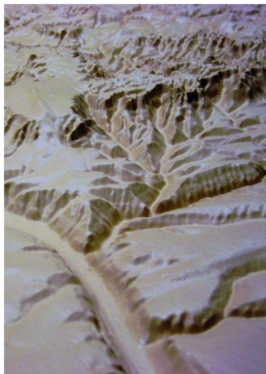
Abb. 2: Geländemodell der Sächsischen Schweiz, Programmierung und mehrachsige Fräsbearbeitung
