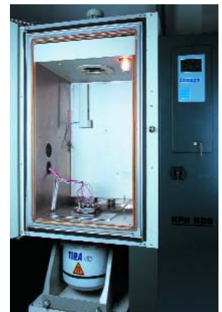
■ Schwingprüfung von Sensoren oder Baugruppen im vorgegebenen Temperaturbereich
