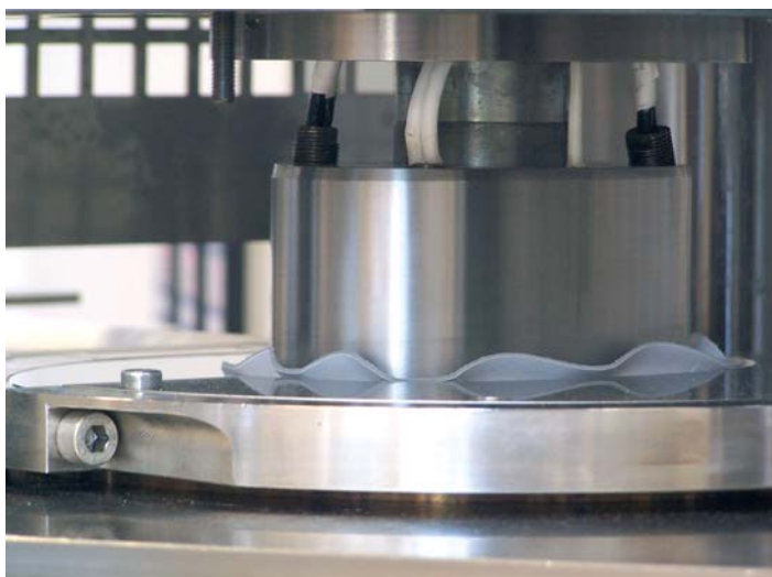
Einblick in das Verarbeitungssystem beim Ziehen von Karton
