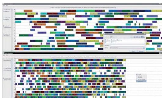
Visualisierte Durchlaufzeitreduktion bei überlappender Fertigung (Quelle: TUD)
