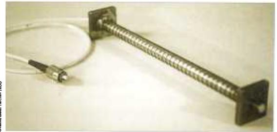
Dehnungssensoren zur Bauwerksüberwachung sind ein Einsatzgebiet für Faser-Bragg-Gitter in der Praxis
