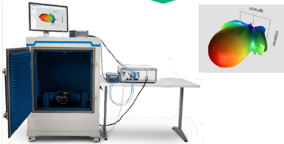
HF-Messkammer mit NI Steuer- und Messsystem
