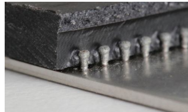
Hochbelastbare Verbindung von Metall- und Kunststoff mit Hilfe einer additiven Verklammerungsstruktur Bildquelle: Fraunhofer IWS Dresden
