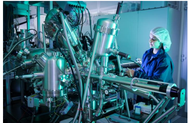
Im ForLab DCST der TU Dresden werden Anlagen für die interdisziplinäre Erforschung von Schaltungen aus Nanodrähten aufgebaut. (Quelle: TU Dresden/IHM)
