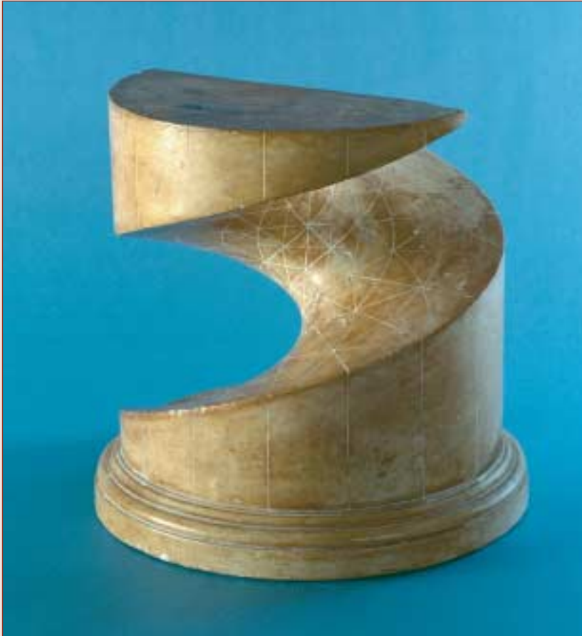
Wendelfläche mit erzeugenden Linien und Krümmungslinien (krummlinig begrenzte Flächen). Das 23 cm hohe Modell ist ein Abguss des Originals aus dem Mathematischen Institut der damaligen Königlichen Hochschule in München.
