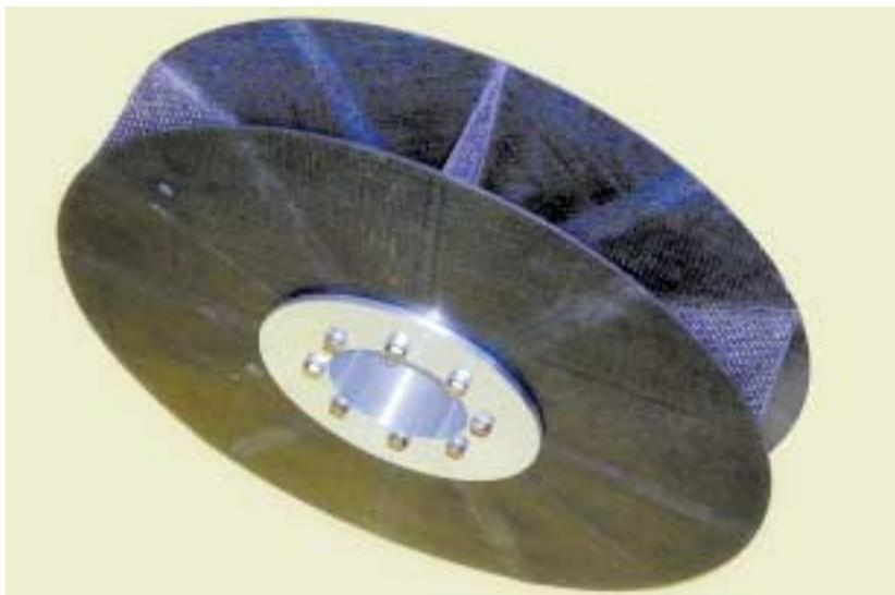
Den federleichten Dresdner Hochleistungsrotor mit Kohlenstofffasern pressen die Leichtbauingenieure als komplette Einheit im Autoklaven.
