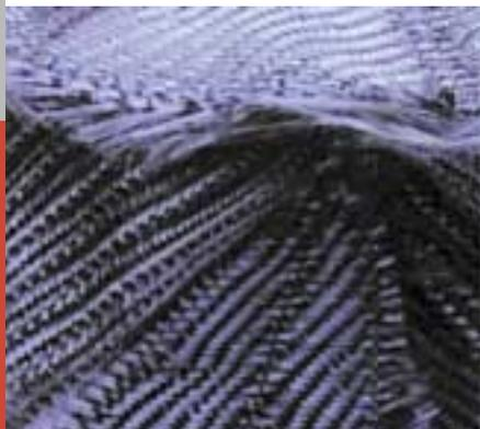
Eine spezielle Nähtechnik verstärkt den Rotor.
