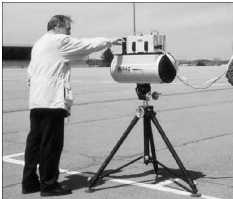
Das FTIR-Spektrum befindet sich im Kasten auf dem Teleskoprohr. Auf eine Schornsteinspitze gerichtet, registriert es die Strahlung der warmen Abgase.
