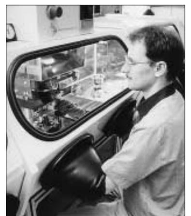
Entwicklungsingenieur Kai Stephan verschleißt an der Verkappungsmaschine unter einer Stickstoffatmosphäre die Sensoren mit einer Metallkappe.
