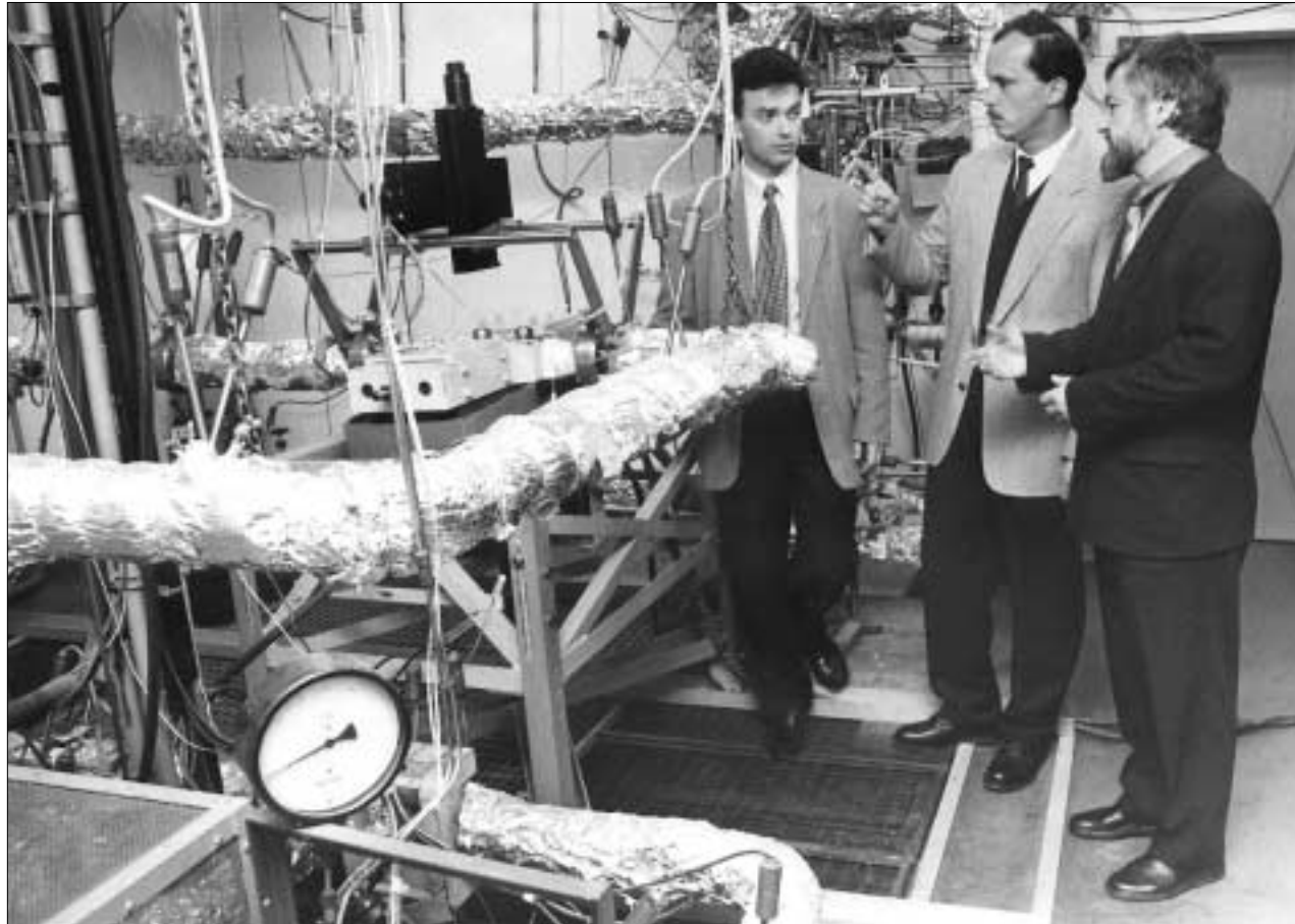
Neues Innovationskolleg: Was im Foto eher wie ein Heizungskeller wirkt, ist in der Realität eine komplizierte Meßanlage zur Grundlagenforschung. Die Rossendorfer Natrium-Umlaufschleife, an der Dr. André Thess, Dr. Gunter Gerbeth und Professor Roger Grundmann (v.l.n.r.) fachsimpeln, dient unter anderem zur Strömungsmessung in nicht durchsichtigen Flüssigmetallen.
