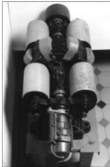
Abbildung 2: Gleichstrommaschine der Firma Siemens & Halske aus dem Jahr 1872
