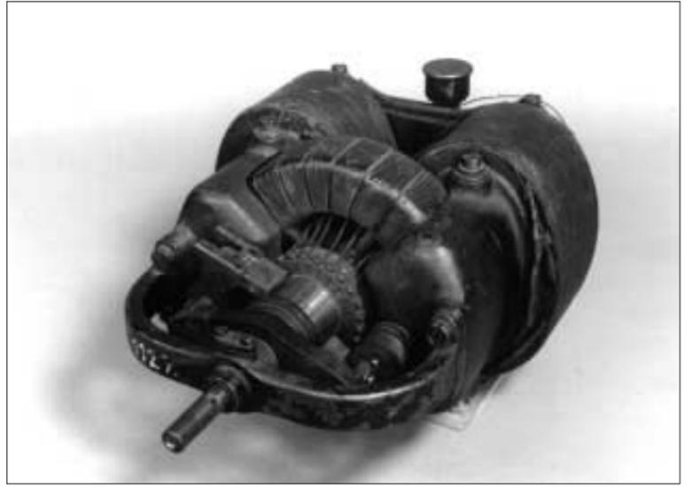
Abbildung 3: Gleichstrommotor von der Dresdner Firma O.L. Kummer & Co.
