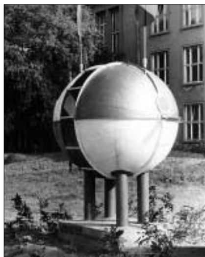
Ulbricht'sche Kugel, benannt nach dem Elektrotechniker Richard Ulbricht (1849-1923). Fotos (2): AVMZ
