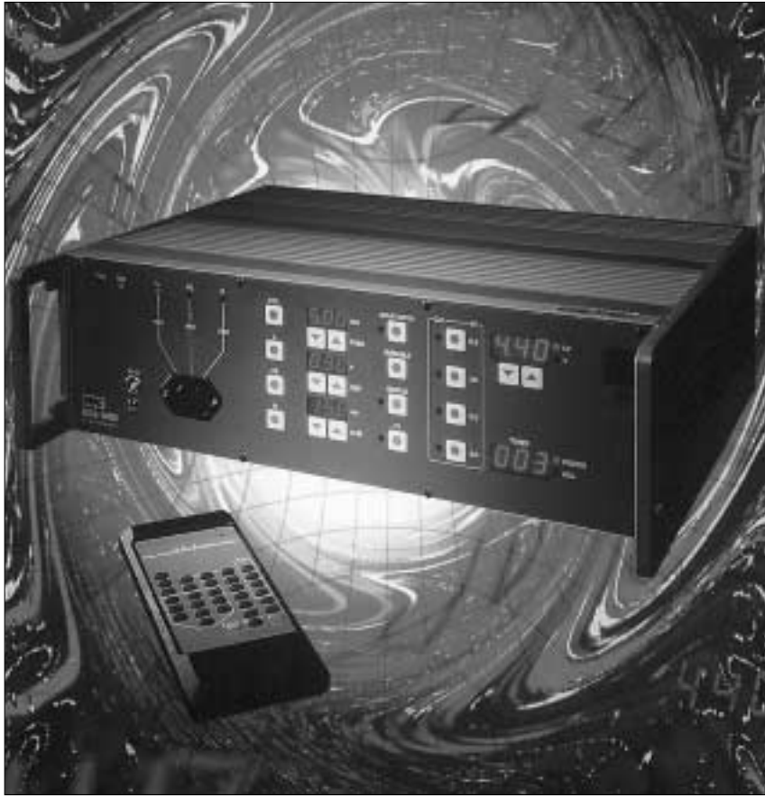
Seit 1. Januar 1996 müssen alle elektronischen Geräte, die auf den europäischen Markt kommen, ein CE-Zeichen tragen. Der Burst-Generator (Foto) sendet kurze Hochspannungsimpulse ins Netz, mit denen die Empfindlichkeit der zu prüfenden Geräte getestet wird. Foto: PR
