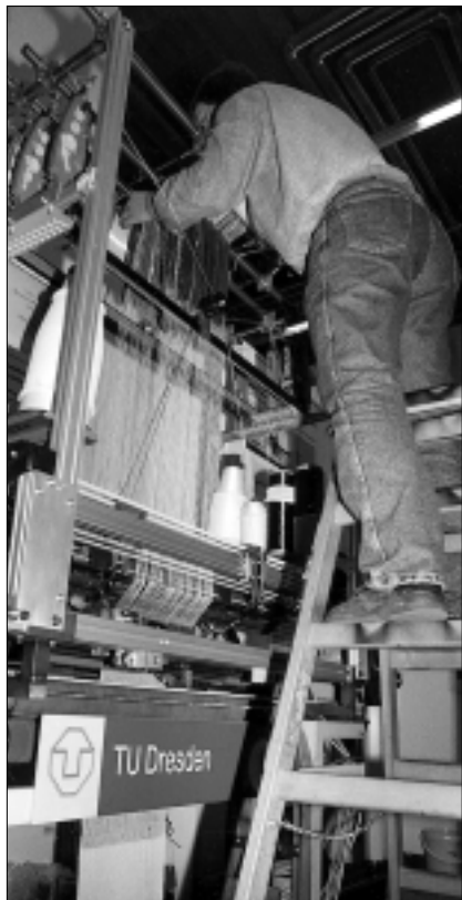
Dipl.-Ing. Godau beim Aufbau der Biaxial-Flachstrickmaschine auf dem Messestand. Foto: Archiv Institut
