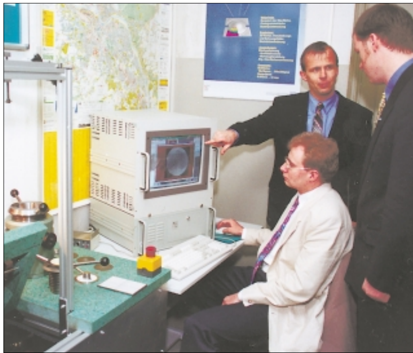
Dr. Lutz Lachmann (l.) demonstriert Tagungsteilnehmern den Bildverarbeitungsmeßstand im Zeunerbau, der zur Analyse von Blechumformvorgängen dient. Foto:UJ/Eckold
