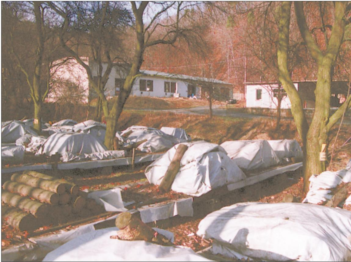
Versuchsstand für die Schutzgaslagerung von Holz. Im Hintergrund die Versuchshalle für die Werkstoffbildung
