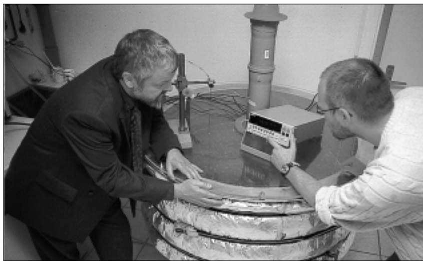
Zur Abbildung: Versuchsstand „Modellierung der Konvektion beim Elektronenstrahlverdamfen“
