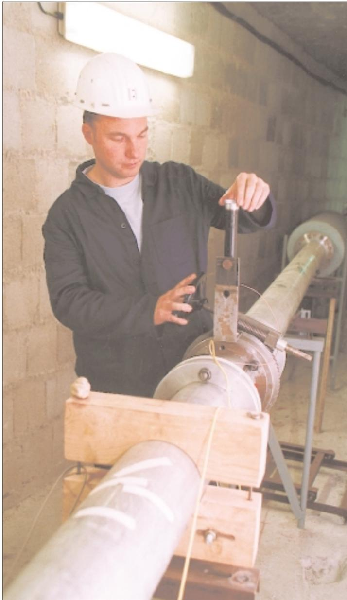
Die TU Dresden verfügt über den größten Hochgeschwindigkeitswindkanal Europas in Merkers / Thüringen. Hier: Steffen Niebergall nimmt eine Einstellung an der Verschiebevorrichtung für Hitzdrahtsonden des Rohrkanals vor. Lesen Sie den Artikel auf Seite 2!
