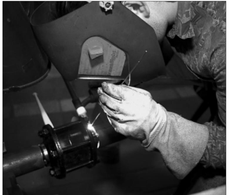
Präzisionsarbeit aus dem Mollierbau. Mit den Schweißarbeiten für den neuen Hochtemperaturprüfstand haben die Kollegen des Werkstattverbundes gezeigt, was sie drauf haben. Foto: UJ/Eckold
