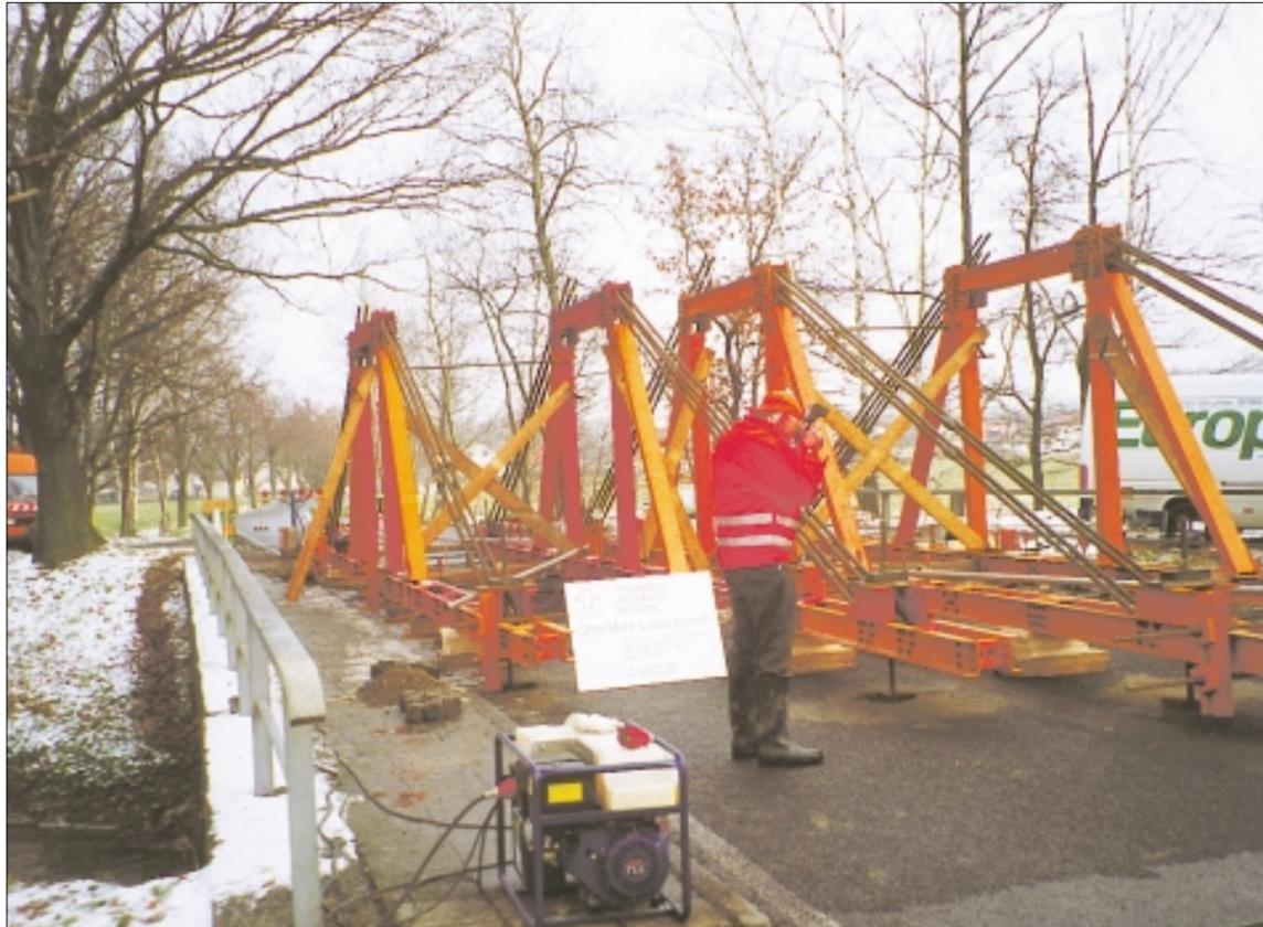
Im vorliegenden Fall wurden die Lasten mit zwölf hydraulischen Pressen, die in baukastenförmig zusammenstellbaren Fachwerkaufbauten verankert waren, eingetragen. An der Brücke in Maukendorf konnten gegenüber rechnerischen Nachweisen erhebliche Tragreserven festgestellt werden. Foto: Opitz
