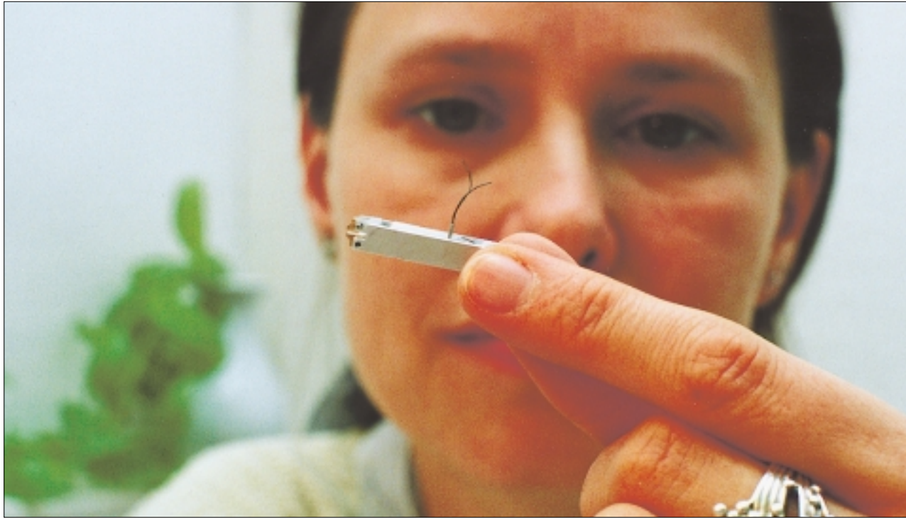
Womit lassen sich sehr kleine, empfindliche oder nachgiebige Bauteile greifen? Mit herkömmlichen Werkzeugen nicht. Das Foto zeigt die Lösung: Minigreifer mit Formgedächtnis-Aktor, wie sie am Institut für Feinwerktechnik der TU Dresden verwendet werden. Foto: UJ/Eckold
