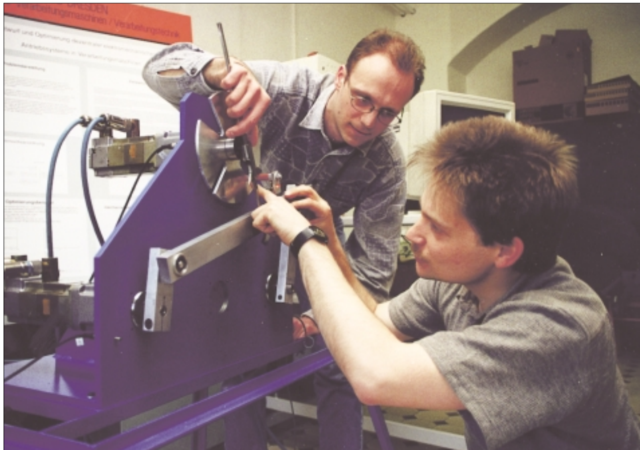
Am Versuchsstand mit Viergelenk und Servomotoren demonstrieren Rolf Blümel (r.) und Holger Grzonka, wie ihr Entwurfswerkzeug komplizierte Bewegungen in Verpackungsmaschinen ermöglicht. Foto: UJ/Eckold
