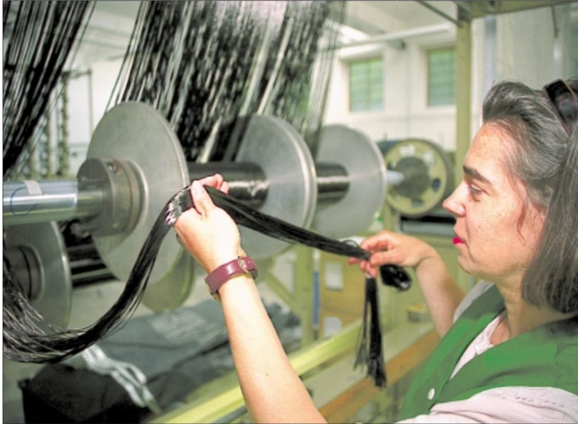
Forschung zum Anfassen. Am Institut für Textil- und Bekleidungstechnik der Fakultät Maschinenwesen wird mit Carbonfasern gearbeitet, die als Verstärkungsmaterial für Hochleistungsrotoren verwendet werden. Fotos (2): UJ/Eckold
