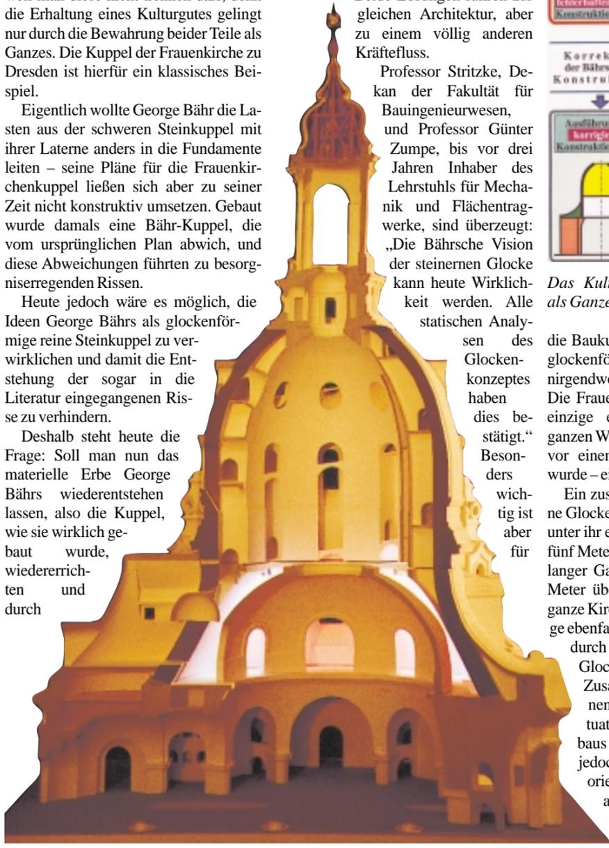
Bild 1: So hatte sich George Bähr die Glockenkonstruktion gedacht: Über die gewölbte Glockenfläche werden die Kräfte auf die Außenmauern abgeleitet.
