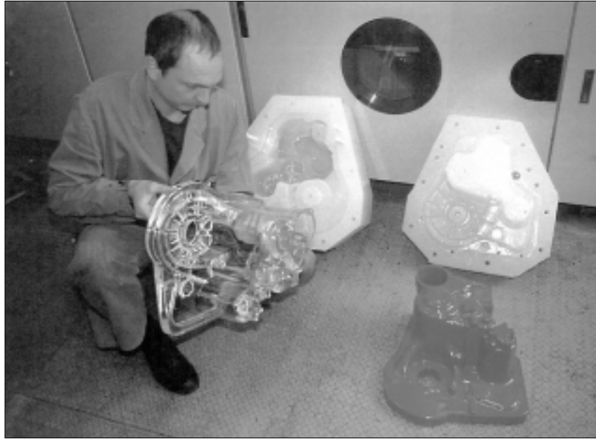
Mit der neuen Vakuumgießanlage können beliebig komplexe Vorlagen dupliziert werden. Die Form aus Silikonkautschuk reicht für bis zu 25 Werkstücke Foto: IPT
