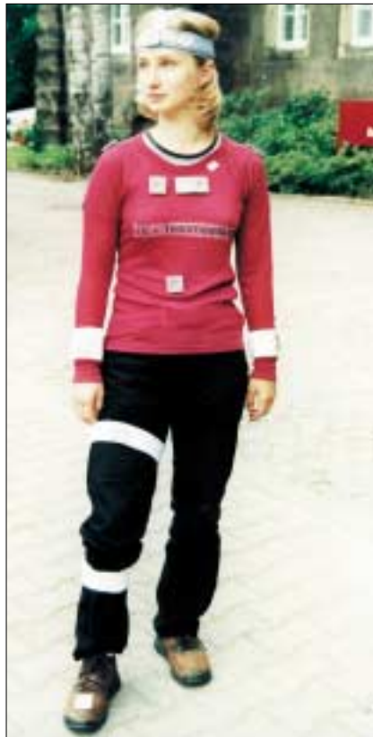
Die Personendosimeter wurden im Brustbereich getragen. Bei einigen Probanden wurde exemplarisch die Verteilung der UV-Exposition über den Körper mit 19 Messpositionen pro Person erfasst. Foto: Knuschke
