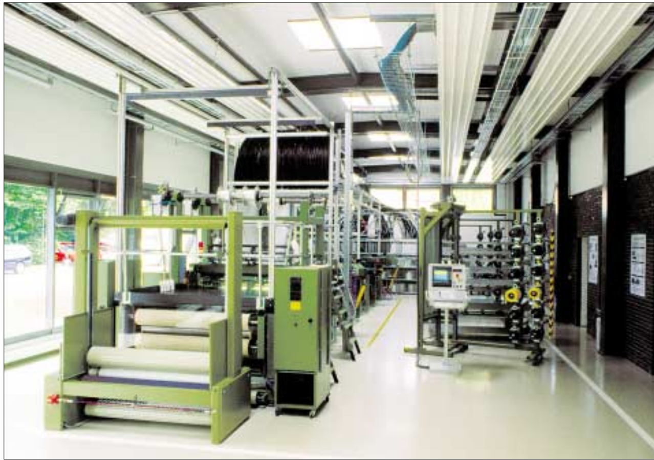
Die neue Textilmaschinenhalle und die Multiaxialwirkmaschine sind Teil des künftigen Kompetenzzentrums „Technische Textilien“. Hier werden textile Flächen zur Bewehrung von Betonbauteilen hergestellt und getestet. Foto: L. Sprenger
