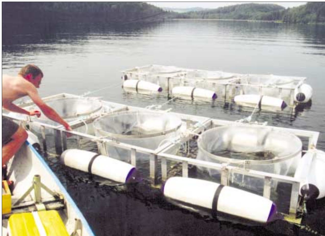
Dr. Robert Radke an der Versuchsanlage des Mesokosmosexperimentes zur Abschätzung des Einflusses der Silberkarpfen auf die Qualität des Wassers in der Saldenbach-Talsperre. Foto: Uwe Kahl
