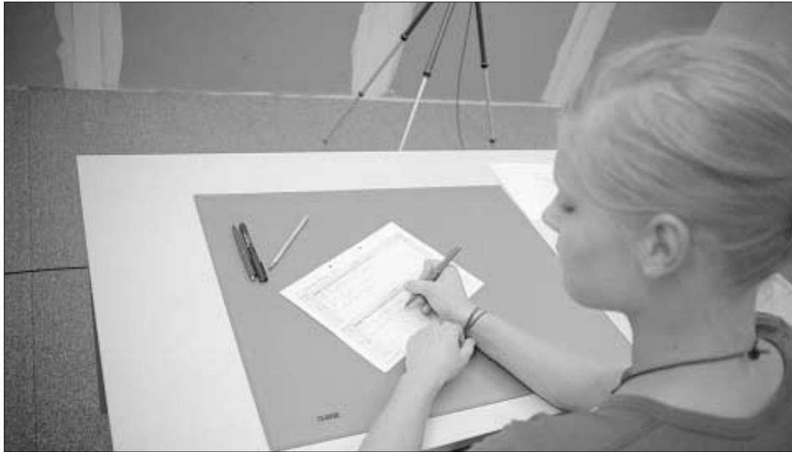
Gymnasiastin Julia Dittler testet die Schalldämmung einer Leichtbauwand. Sie muss genau notieren, welche genormten Töne sie aus dem Lautsprecher hinter der Wand versteht. Hier gilt: Je weniger, desto besser. Foto: UJ/Eckold
