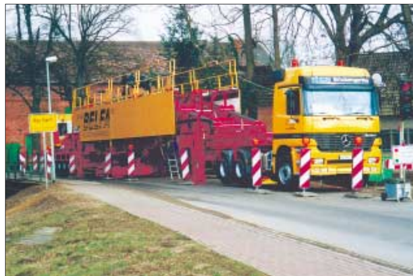
Prüfung einer Brücke bei Ludwigslust (Neu Kaliß) durch das neu entwickelte Belastungsfahrzeug für Tragsicherheitstests. Foto: Beier
