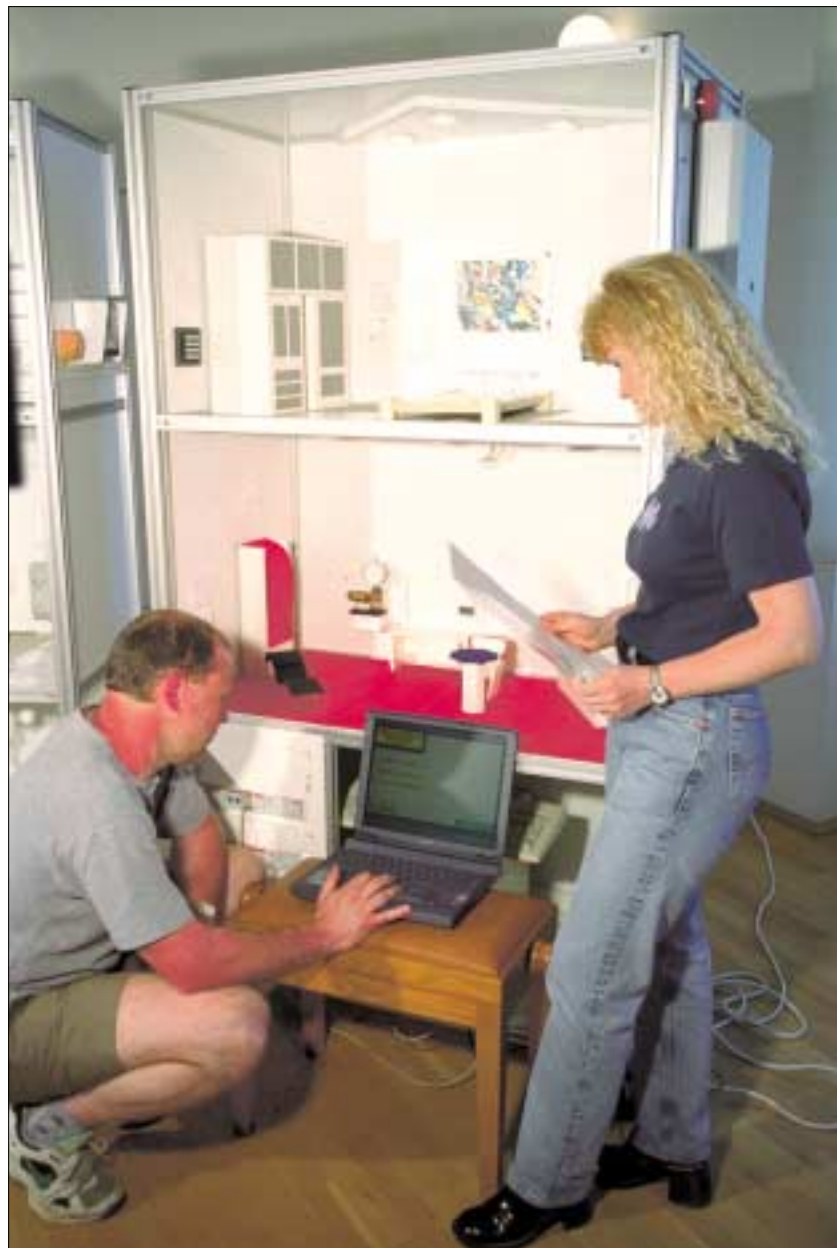
Lehren und lernen am »Gläsernen Haus«: Am Rechner werden Komponenten des automatisierten Gebäudes, wie Beleuchtung und Alarmanlage, gesteuert. Foto: UJ/ Eckold
