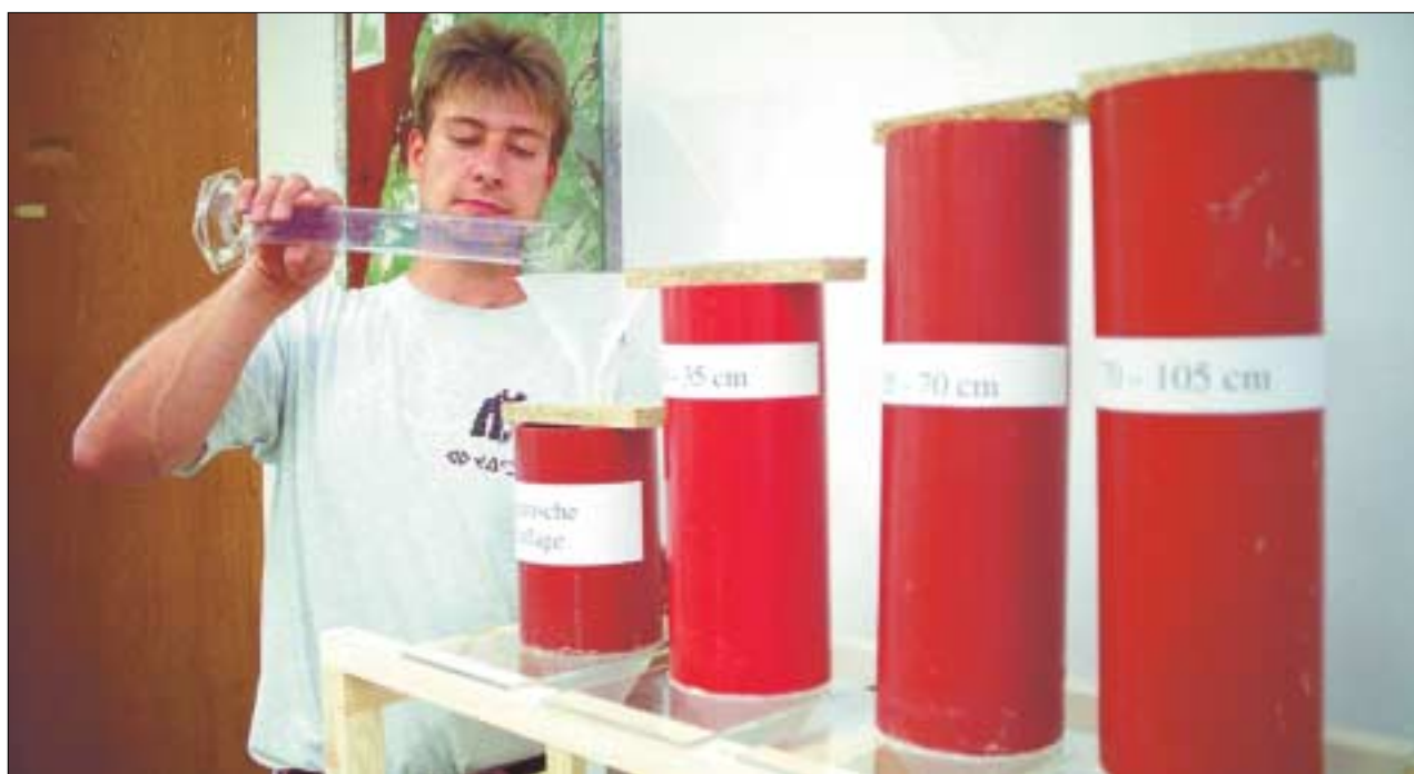
An einer Modellanlage mit unterschiedlichen Bodenschichten simuliert Thomas Scheuner den Stickstoffeintrag. Foto: UJ/Eckold
