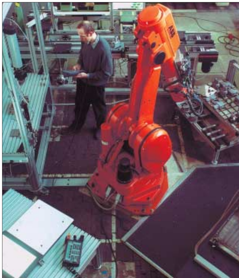
Ein Blick in die Montagezelle der Professur Fügetechnik und Montage (Institut für Produktionstechnik): Dr. Volkmar Flemming programmiert einen Roboter.
