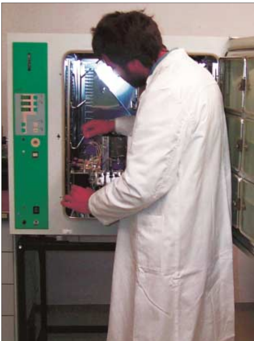
Stefan Krause, wissenschaftlicher Mitarbeiter Physik des IMT, bei der Erprobung eines Perfusionskultursystems mit Prozessdatenerfassung im Brutschrank.
