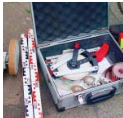
Maßband, Streckenzähler und Meßmarken gehören u.a. zur Ausrüstung der Unfallforscher.
