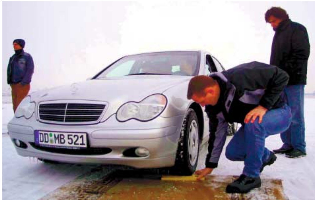
31. Januar 2003, Lausitzring: Studenten der TU Dresden testen die Radlast an einem Fahrzeug.
