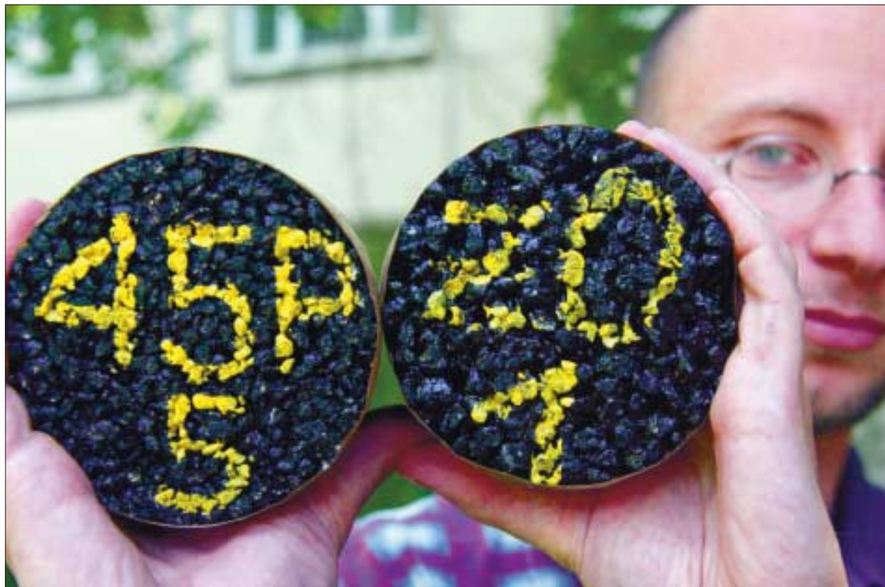
Wie wirken sich Struktur und Material des Fahrbahnbelags auf die entstehenden Rollgeräusche aus? Ennes Sarradj von der TU Dresden macht Untersuchungen – hier mit einem grobkörnigen (re.) und einem feineren (li.) Fahrbahnbelag. Foto: Autor
