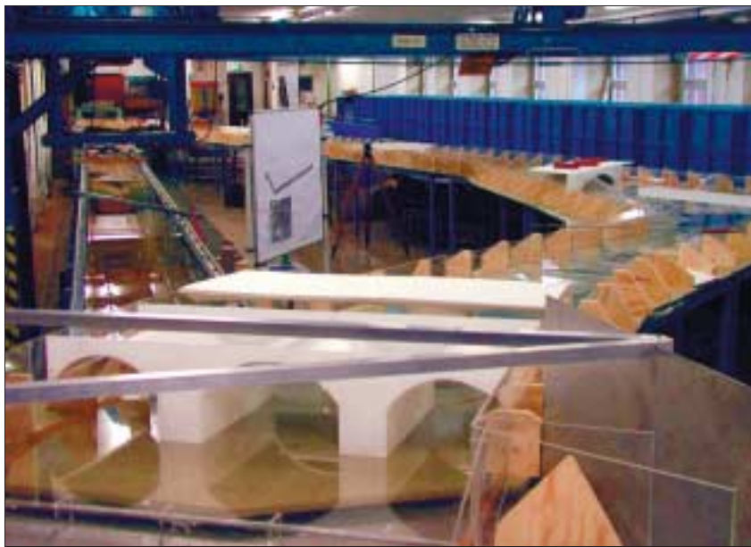
Mit diesem 1:25-Modell untersuchten die TU-Wissenschaftler im Hubert-Engels-Laboratorium den Flusslauf im so genannten Weißeritzknick. Foto: Inst.
